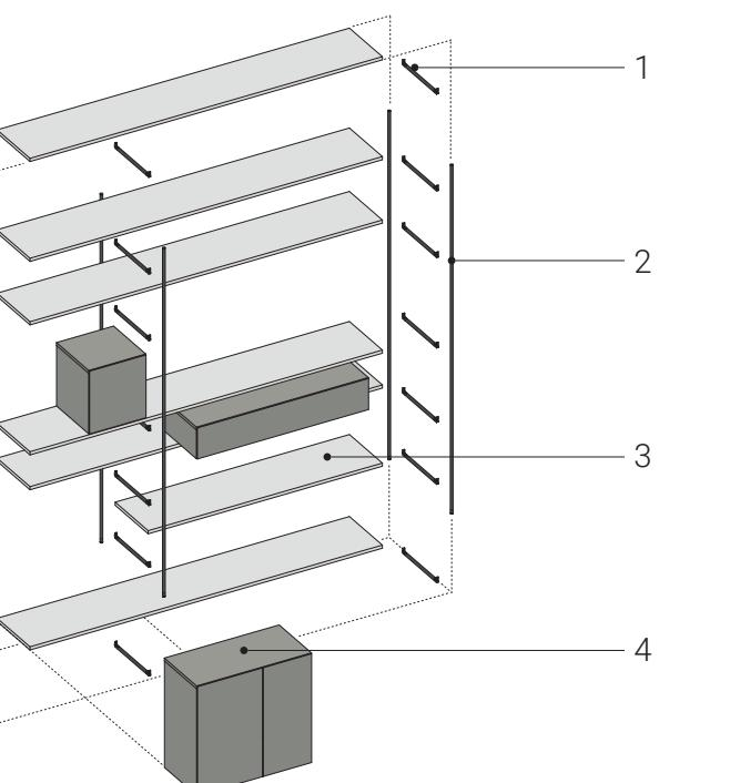
Ripiani in estruso di alluminio spessore 20mm sono stati progettati in ogni minimo dettaglio per ottenere le massime performance di resistenza al carico con il minimo impiego di materiale.
